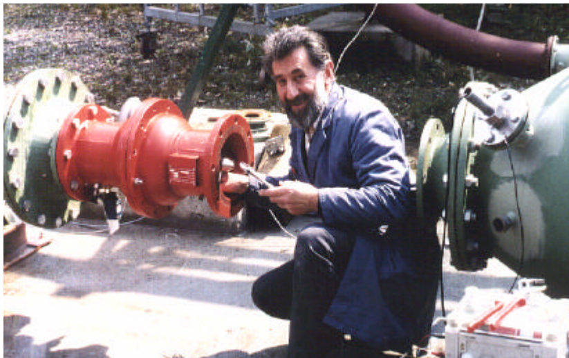
Abbildung 3: Vorbereitung zur Prüfung eines Explosionsschutzventils auf mechanische Festigkeit und Zünddurchschlagsicherheit durch Belastungen mit Staub- und Gasexplosionen.
