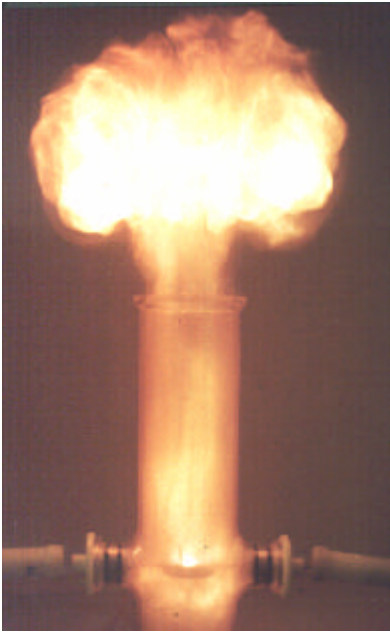
Abbildung 5: Explosionsgefäß zur Bestimmung der Mindestzündenergie von Stäuben.
