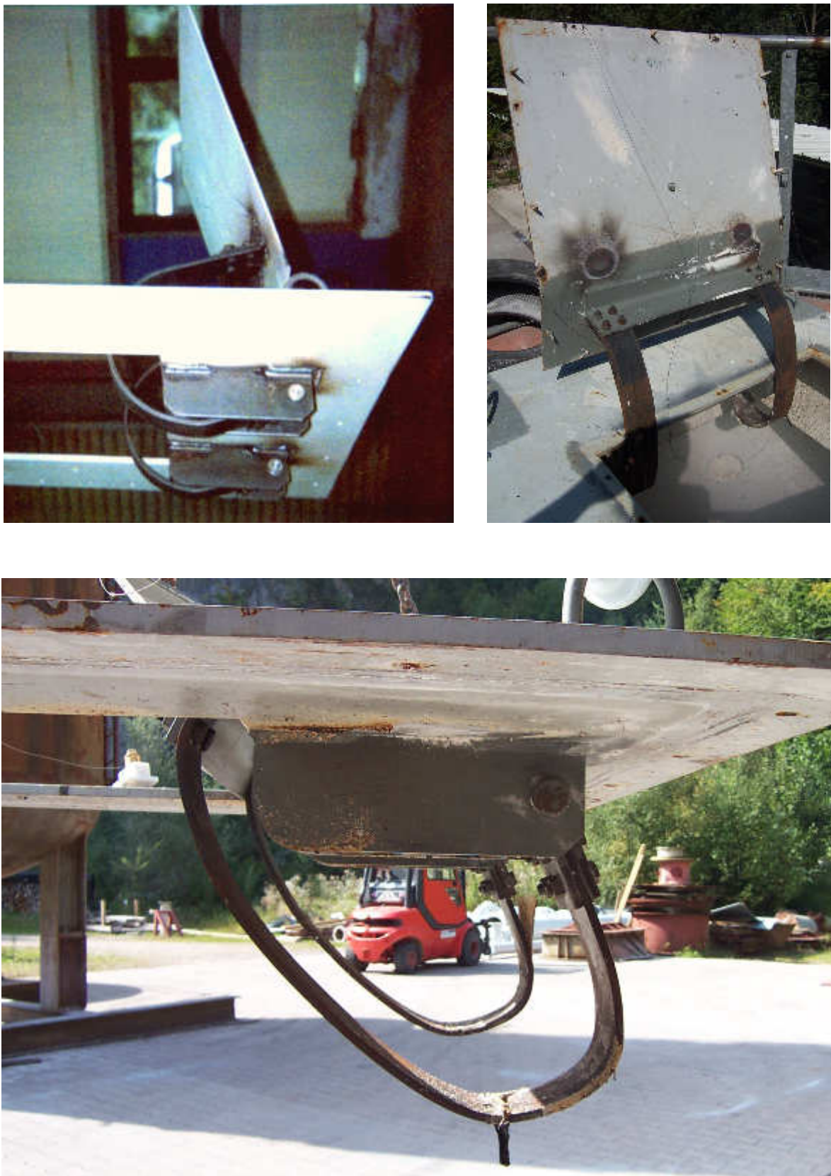
Abbildung 3.10: Die Klappe mit 8 mm-Bügeln nach der Fertigung (oben, links) und nach dem Versuch. Im Bild unten ist die starke Deformation der 8 mm-Bügel durch die Dissipation der Klappenbewegungsenergie deutlich zu erkennen.
