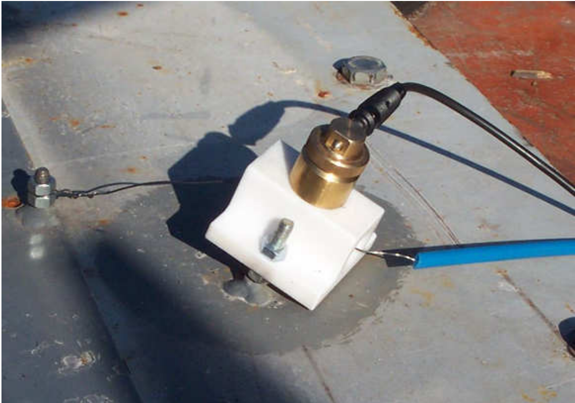
Abbildung 3.6: Ein Schleifkontakt vor einem Versuch. Der Widerstandsdraht ist mit Hilfe einer Schraube an der Klappe befestigt (links). Der blaue Schlauch (rechts) isoliert und schützt den Widerstandsdraht.
