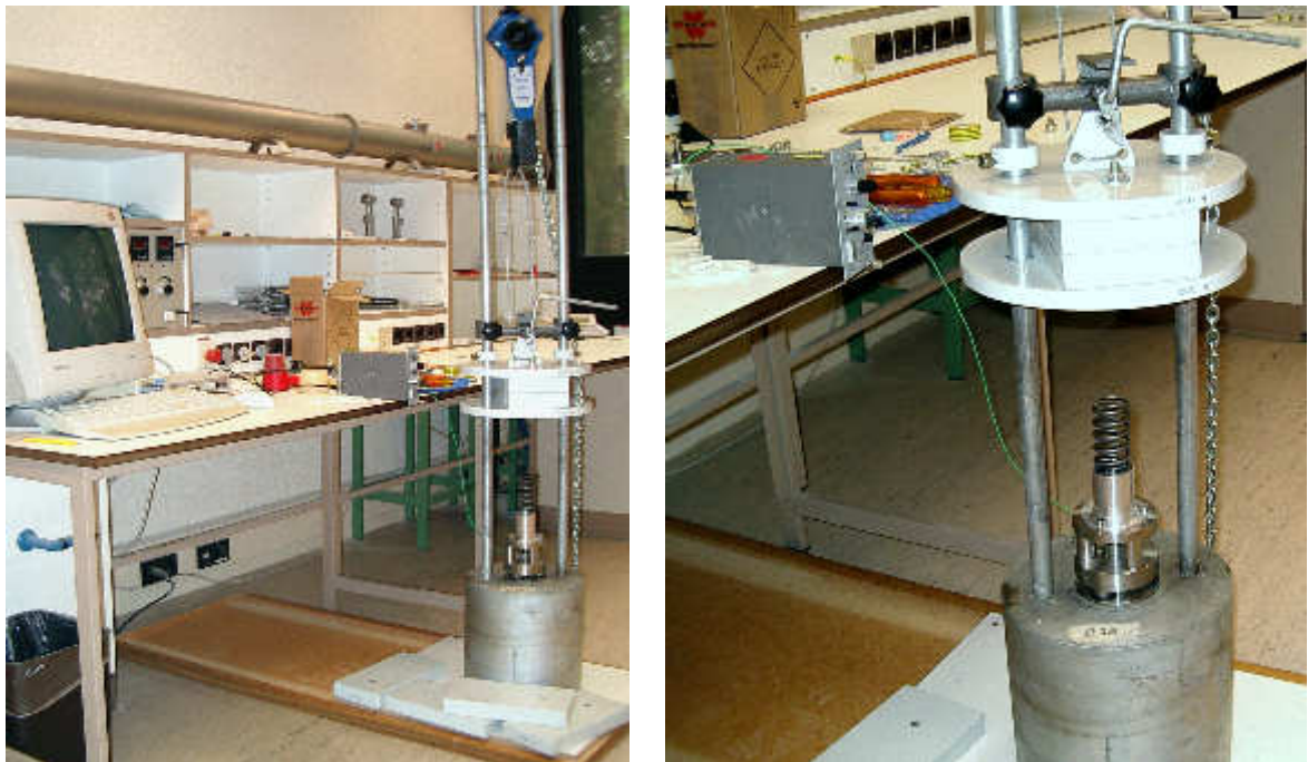
Abbildung 6.16: Versuchsausrüstung zur Bestimmung der dynamischen Schraubenbruchlast.
