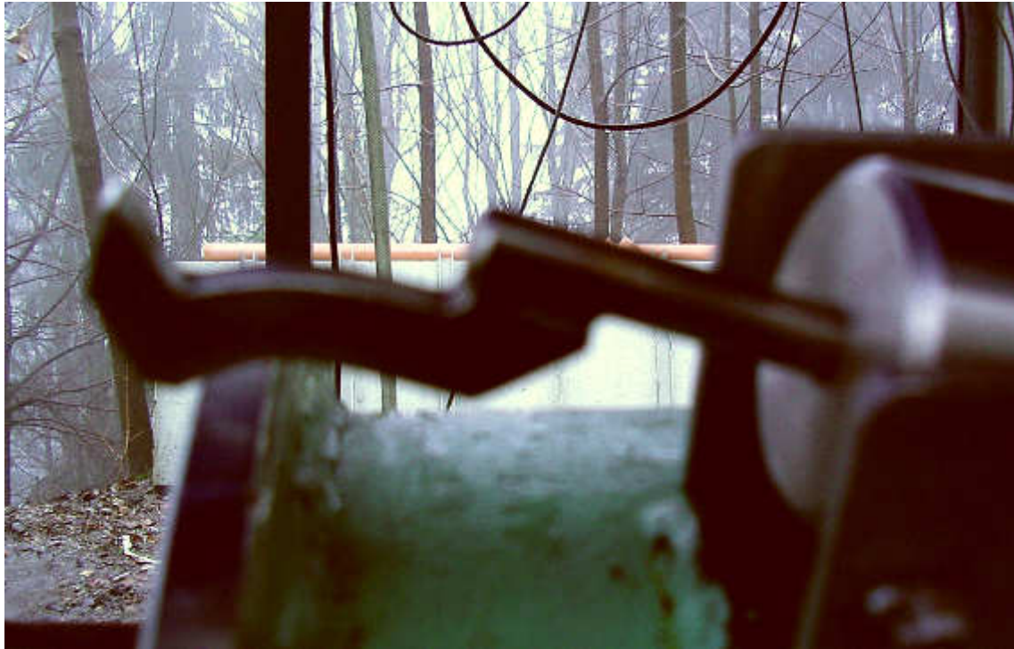
Abbildung 6.6: Verbogener Haken nach Versuch Nr. 2.
