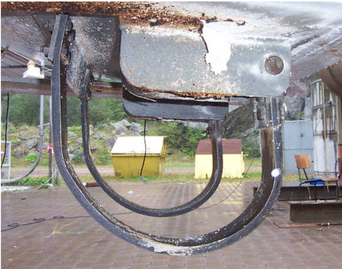
Abbildung 3.11: Die Bügel mit 8 mm (links, oben) und 10 mm (rechts, oben) Stärke nach den Versuchen. Unten sind die 14 mm starken Bügel kurz nach dem Versuch zu sehen. Diese Bügel sind kaum verbogen worden.
