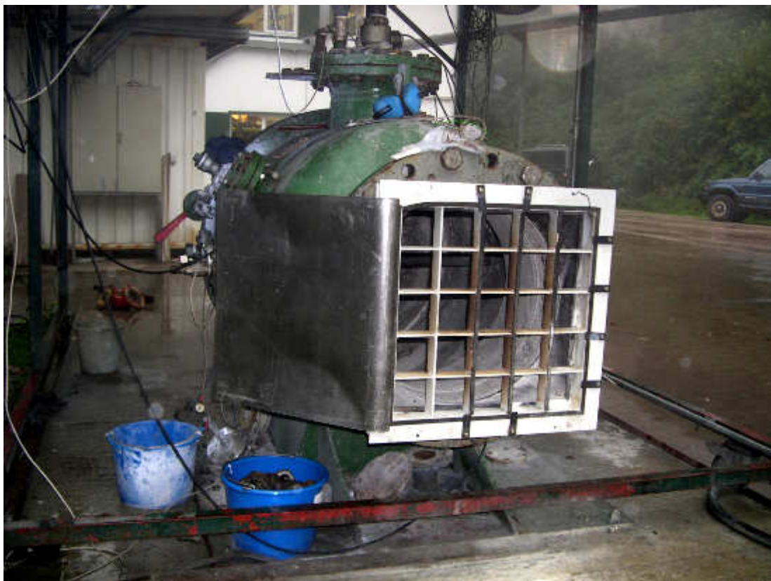
Abbildung 5.2: Aufgebogene Blechklappe nach Versuch Nr. 1 (oben) und Versuch Nr. 5 (unten).
