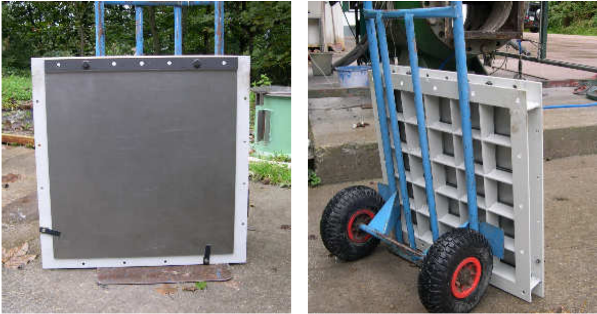
Abbildung 5.1: Links: Gitterrahmen mit montiertem Entlastungsblech sowie zwei Haltetaschen. Rechts: Fertig vorbereiteter Gitterrahmen kurz vor der Montage auf den 1 m 3 -Behälter, der im Hintergrund (oberer Bildrand) zu sehen ist.
