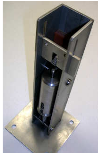
Abbildung 6.2: Prinzip-Bild der Funktionsweise des Hakenverschlusses (links). Zur detaillierten Funktionsbeschreibung siehe laufenden Text. Fertig hergestellter Hakenverschluss (rechts).
