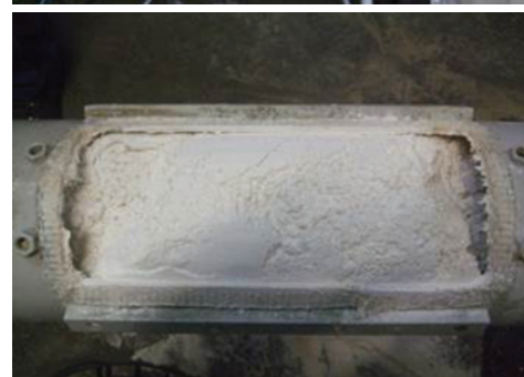
Bild 4 Schüttgutpfropfen mit Cellulose (Bild unten) und lediglich Schüttgut-Anhäufung mit Maisstärke (Bild oben) in der Rohrförderschnecke nach abgeschalteter Schüttgutzufuhr. Im gezeigten Beispiel wurden anderthalb Schneckengänge entfernt (horizontale Einbaulage).
