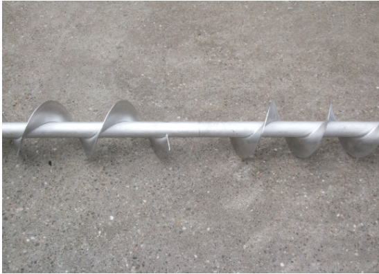
Bild 1 Ausgebaute Schneckenwelle, bei der ein Schneckenangang entfernt wurde. Es standen zwei zusätzliche Schneckenwellen mit anderthalb und zwei herausgetrennten Schneckenängängen zur Verfügung.
