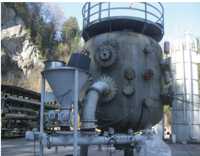
Bild 3 Praktische Realisierung des Versuchsaufbaus mit 26-m 3 -Explosionsbehälter. Im Vordergrund sind die Rohrförderschnecke und die Schüttgutaufgabe zu sehen.
