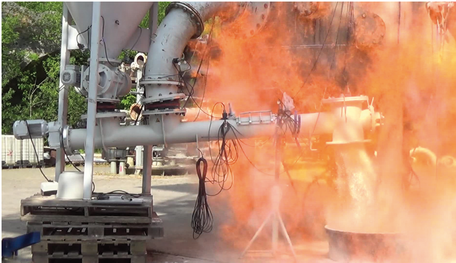
Bild 6 Explosionsversuch mit Maisstärke und Flammenübertragung durch die Rohrförderschnecke hindurch.
