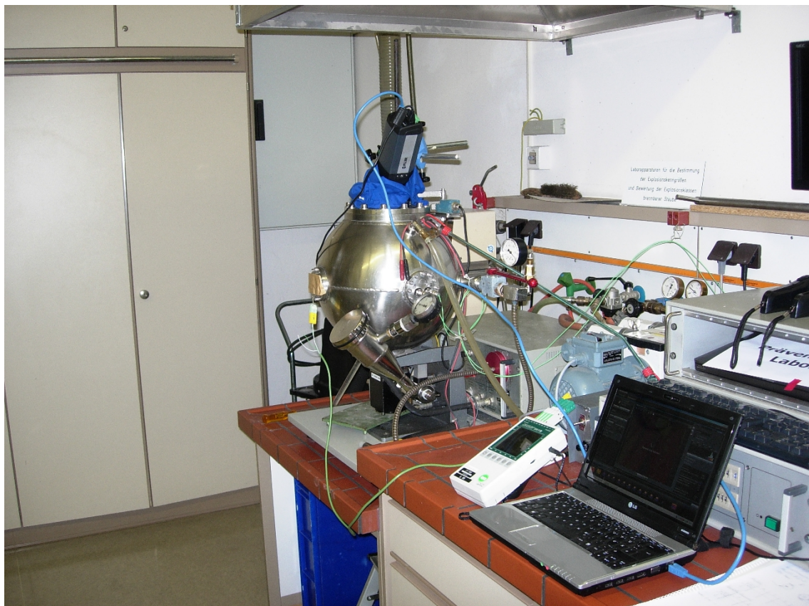
Abbildung 3.7: Versuchsanordnung zur Bestimmung des Emissionskoeffizienten der Kugelinnenwand.
