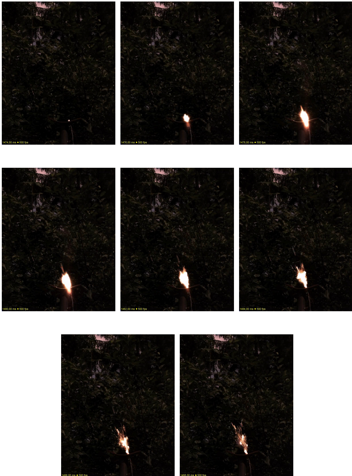
Abbildung 3.11: Zeitliche Entwicklung des Zündradius eines pyrotechnischen Zünders mit 100 J Energieinhalt.
