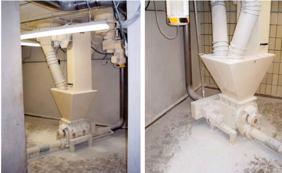
Bild 4: Produkteinspeisung in eine pneumatische Förderanlage
