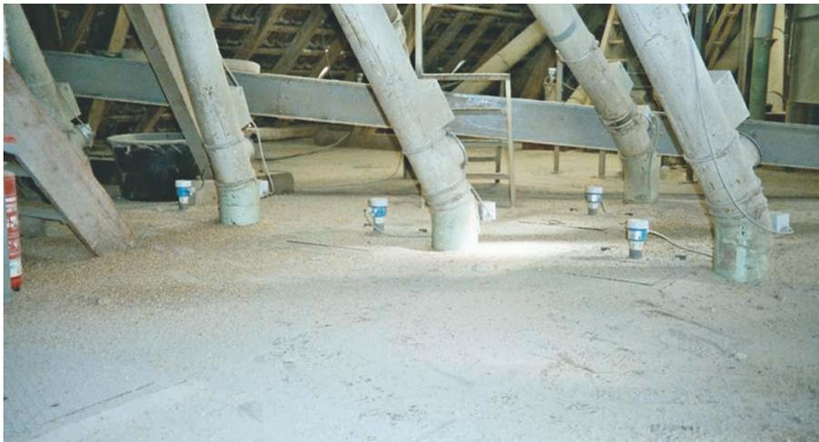
*Bild 2: Beispiel für „schlechte“ Reinhaltung auf dem Siloboden, daher Zone 22 (Markierung nicht mehr sichtbar)*
