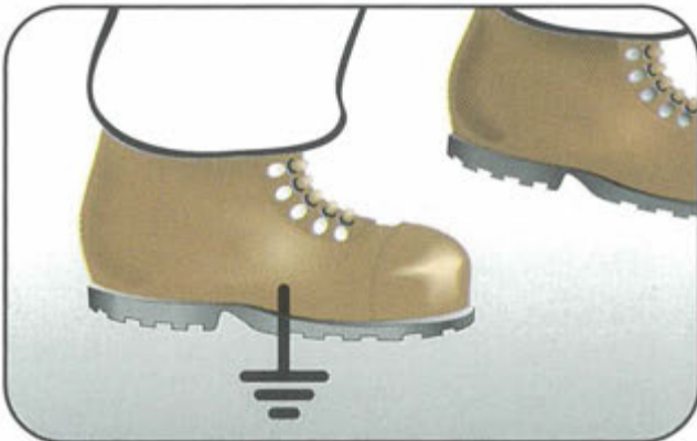
Abb. 36: Beispiele von Massnahmen beim Umgang mit brennbaren Flüssigkeiten in der Praxis: Nur leitfähige Gebinde verwenden und beim Umfüllen erden. Alle leitfähigen Anlageteile (z.B. auch Fasspumpe) beim Umfüllen erden. Personen über ableitfähige Schuhe und ableitfähigen Fussboden erden.
