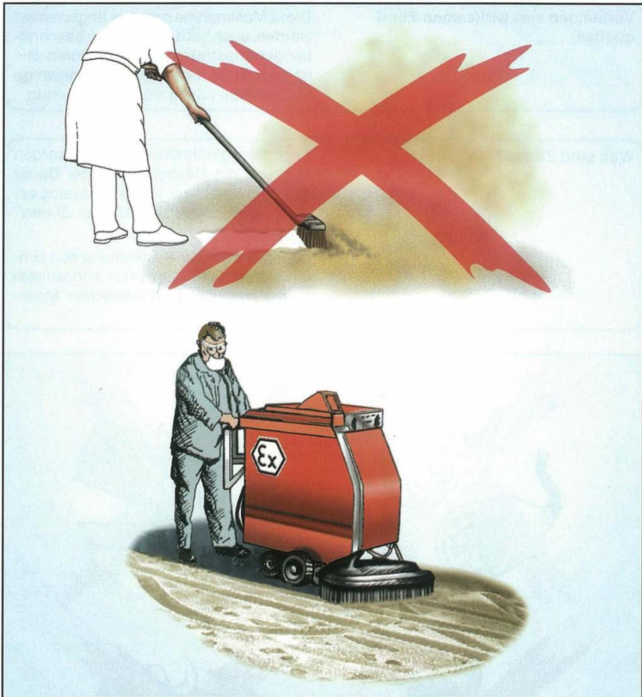
Bild 8: Vermeiden von Staubaufwirbelungen durch Absaugen
