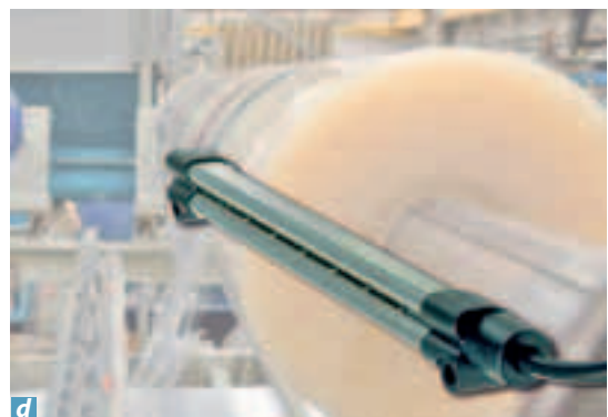
Bild 26 Beispiele für das Vermeiden von Funkenentladungen: a) Ladungsableitung durch Erden aller leitfähigen Teile und Produkte und Tragen von ableitfähigen Schuhen b) Überwachung der Erdung mit Verriegelung c) Erden von Flanschen an Rohrleitungen d) Neutralisieren von Ladungen durch Ionisatoren
