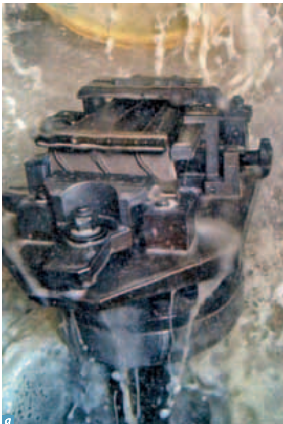
Bild 19 Vermeiden von mechanisch erzeugten Funken: a) Feuchthalten/Kühlung von Schleifstellen b) Begrenzen der Umfangsgeschwindigkeit c) Verwenden von funkenarmen Werkzeugen bei möglicher explosionsfähiger Atmosphäre von Stoffen mit sehr niedriger Mindestzündenergie (z. B. Acetylen)
