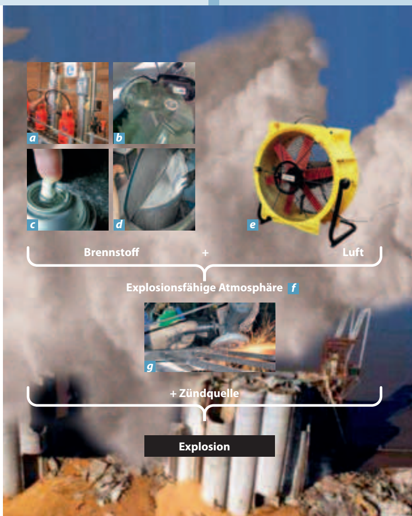
Bild 2 Brennstoff { a ) Gas, b ) Dampf, c ) Nebel oder d ) Staub} + e ) Luft → f ) explosionsfähige Atmosphäre + g ) wirksame Zündquelle → Explosion
