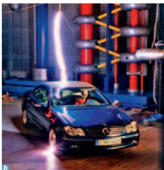
Bild 28 Blitzschutz: a) Blitzschutzanlage b) «Faraday'scher Käfig»
