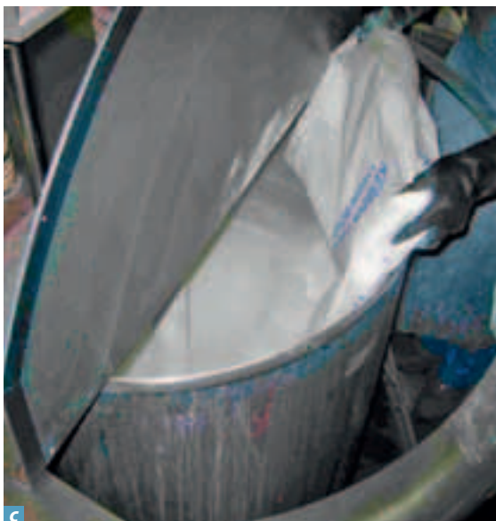
Bild 8 Explosionsgefährdete Bereiche (Bereiche mit explosionsfähiger Atmosphäre): a) Flüssiggas beim Füllen von Flaschen b) Dämpfe beim Umfüllen von Lösemitteln mit niedrigem Flammpunkt c) brennbare Stäube beim Einschütten d) Nebel beim Farbspritzen
