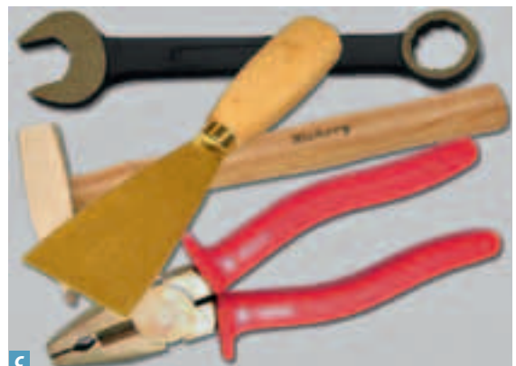
Bild 19 Vermeiden von mechanisch erzeugten Funken: a) Feuchthalten/Kühlung von Schleifstellen b) Begrenzen der Umfangsgeschwindigkeit c) Verwenden von funkenarmen Werkzeugen bei möglicher explosionsfähiger Atmosphäre von Stoffen mit sehr niedriger Mindestzündenergie (z. B. Acetylen)
