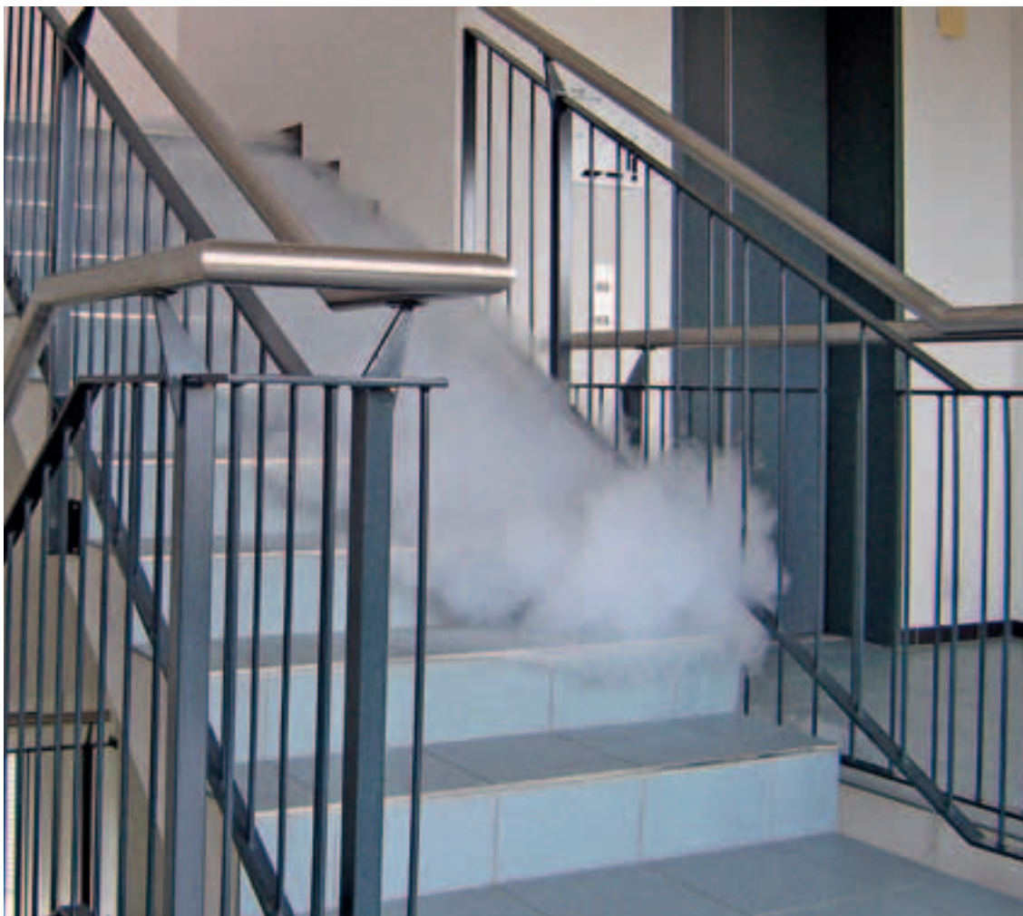
Bild 9 Ausbreitungsverhalten von Dämpfen, Nebeln und Gasen schwerer als Luft (Anmerkung: Gase und Dämpfe sind in der Regel nicht sichtbar)
