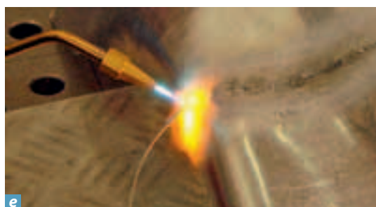
Bild 14 Entstehen von Zündflammen: a) Kohleglut b) Schneiden c) Flammen d) Glimmnest e) Schweißen
