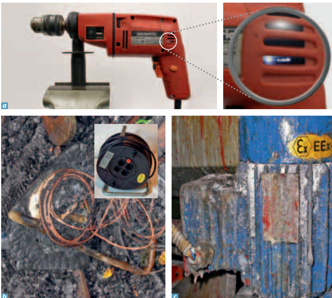
Bild 20 Zündquellen von elektrischen Betriebsmitteln: a) Bohrmaschine mit Funken am Kollektor b) Kabelrolle c) Mangelhafte Instandhaltung von explosionsgeschützten elektrischen Betriebsmitteln (hier noch mit alter Ex-Kennzeichnung)
