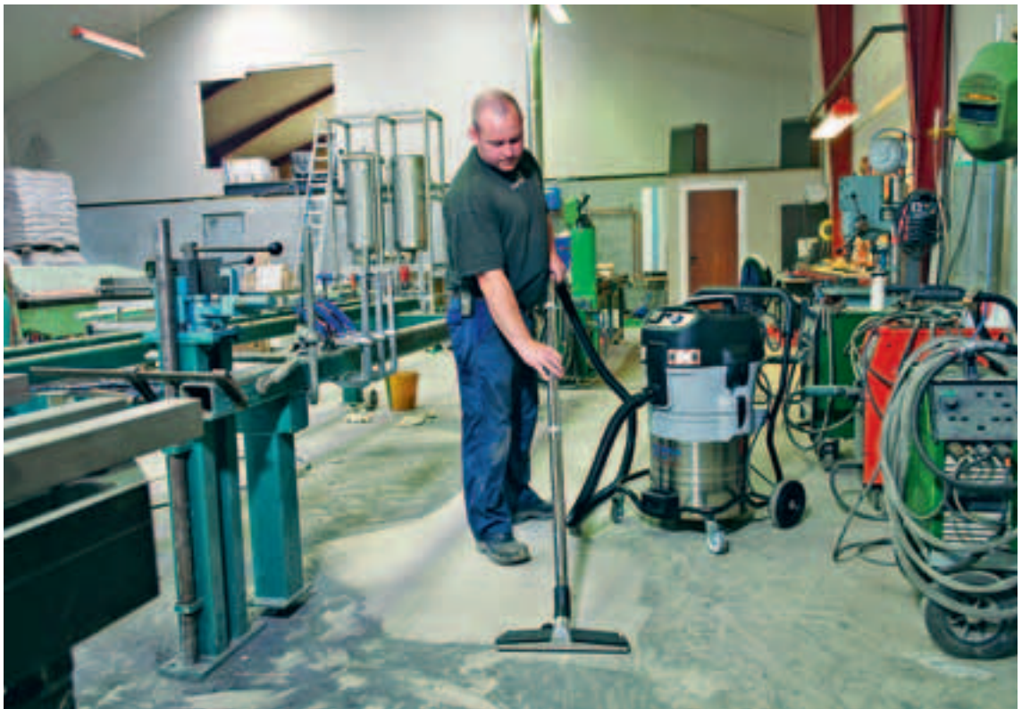
Bild 17 Reinigung (Absaugen von Staubablagerungen)
