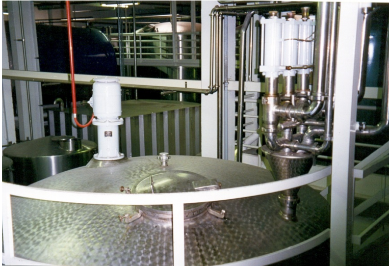
Abb. 23: Mischtank mit explosionsgeschütztem Rührmotor für
